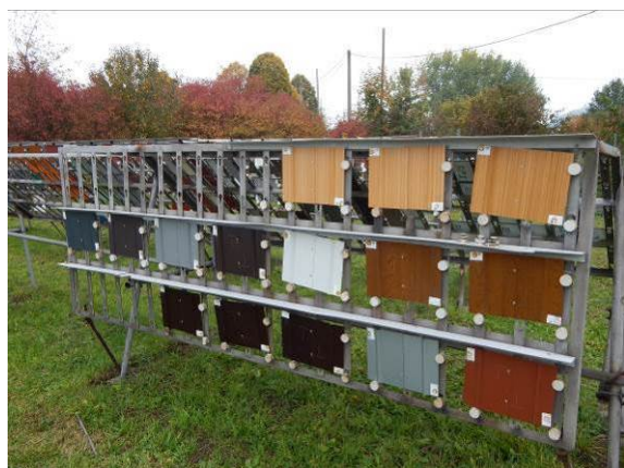
Vzorky z projektů spolupráce s IC Brest/Samples from project of co-operation with IC Brest Vzorky různých typů ocelí (CENIM, JFE)/Samples of various types of steels (CENIM, JFE)
