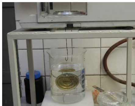
Stanovení hustoty vrstvy prostředku CREPEX/ Determination of density of CREPEX layer
