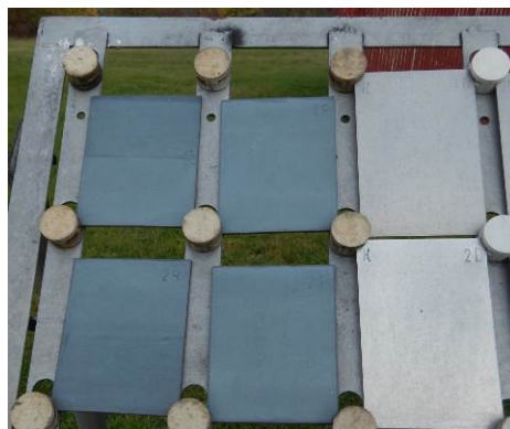
Instalace vzorků povlaku Magnelis na atmosférické stanici/Magnelis coating samples installation at atmospheric test sites
