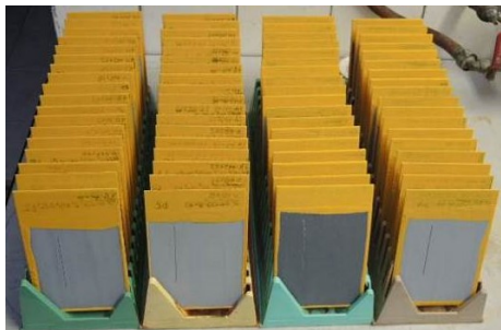
Zkušební vzorky vodou ředitelné silikátové nátěrové hmoty/ testing samples of water-borne silicate coating materials
