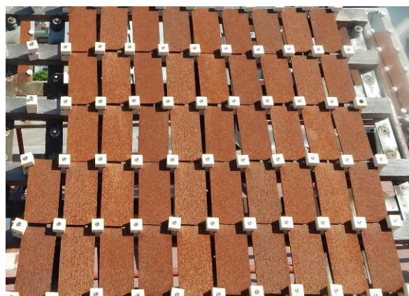
Vzorky z projektů spolupráce s IC Brest/Samples from project of co-operation with IC Brest Vzorky různých typů ocelí (CENIM, JFE)/Samples of various types of steels (CENIM, JFE)
