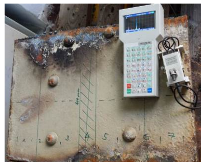
Měření magnetické paměti kovu/ Metal magnetic memory measurement
