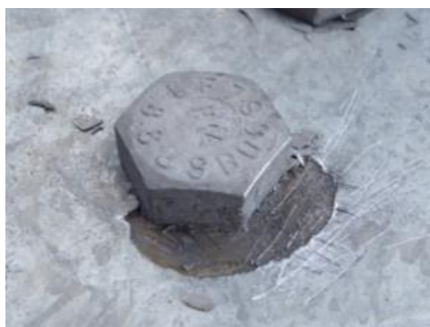
Problémy s přilnavostí žárového povlaku/ Adhesion problems of galvanised coating
